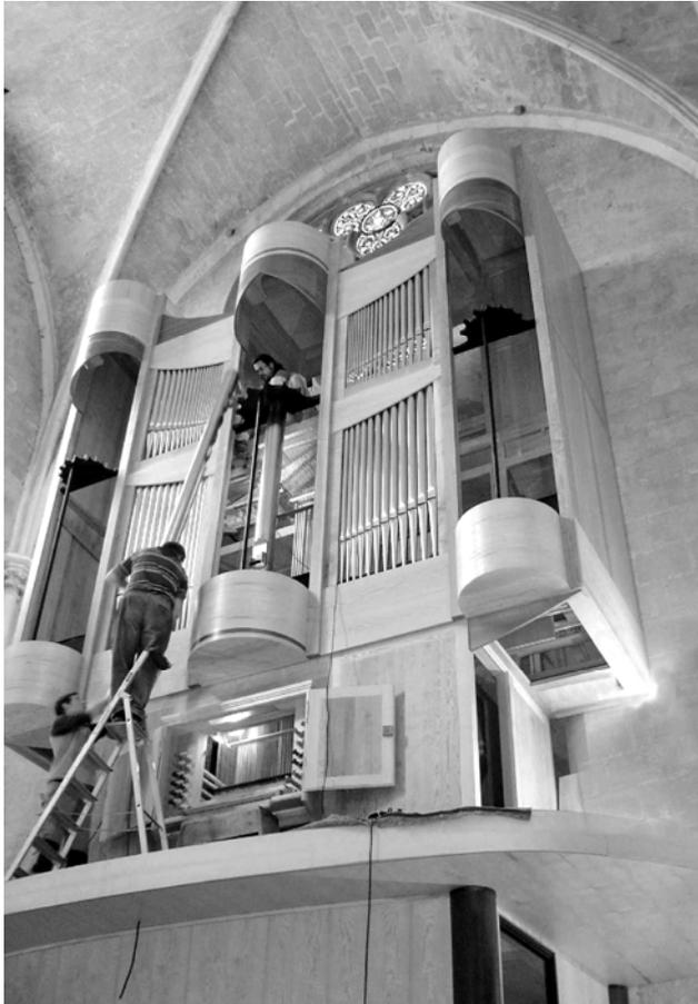
*Illustration 11 : pose d'un tuyau de la montre dans la tourelle centrale*
